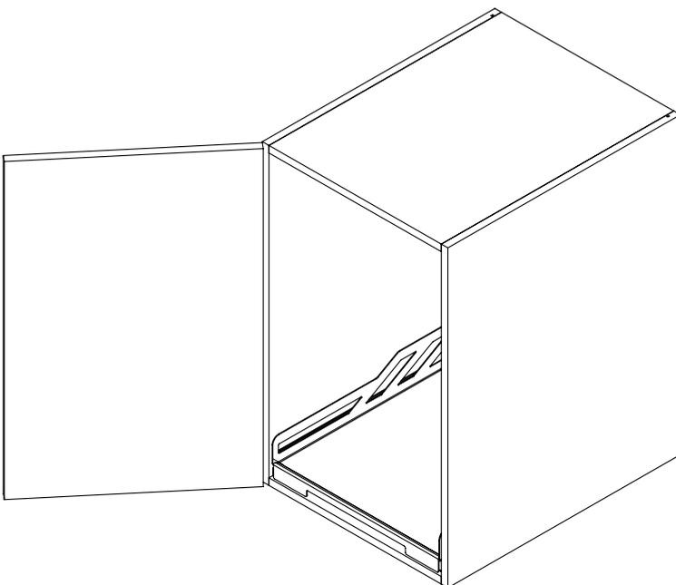
При установке полки за распашной фасад мы рекомендуем использовать петли 155° «нулевого вхождения» .
