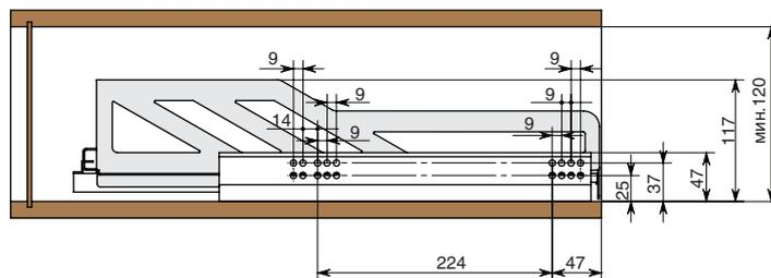
K - внутренний размер каркаса / габаритный размер полки с направляющими
