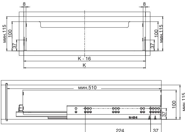
K - внутренний размер каркаса / габаритный размер ящика с направляющими
